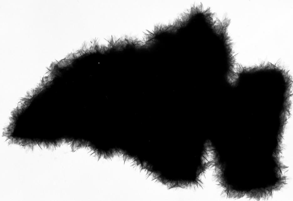
Рисунок 1 – Электронная микрофотография образца сорбционного материала на основе минерала сланец с нановолокнами оксигидроксида алюминия (увеличение в 10 тысяч раз)
