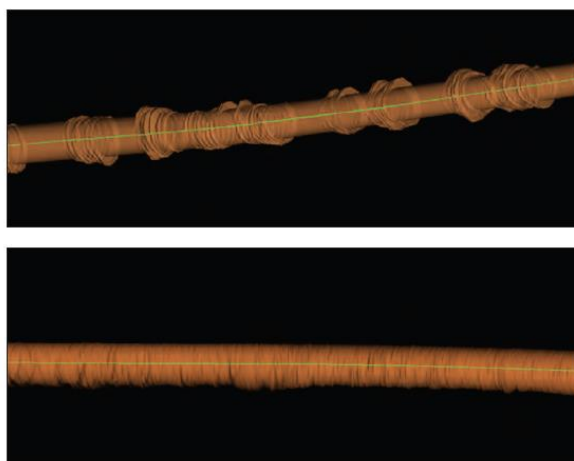
Рис. 2. Сравнение качества ствола скважины, построенного по данным каверномера: сверху – забойный двигатель с кривым переводником, снизу – роторная управляемая система [1]
