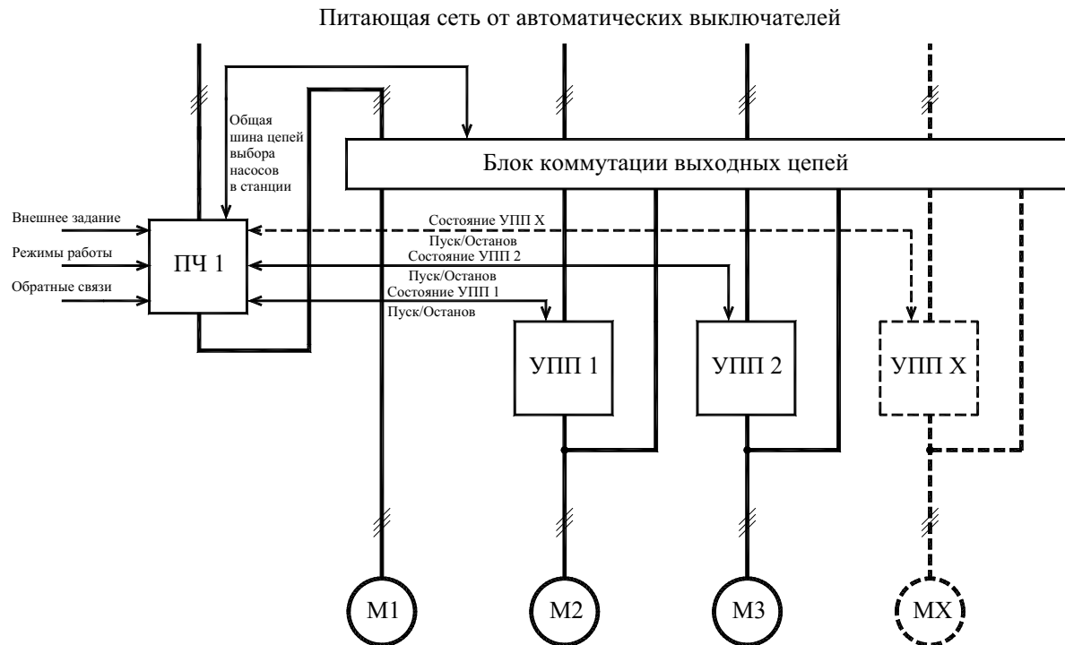
Рис. 3. Функциональная схема системы управления насосной станцией с одним преобразователем частоты и устройствами плавного пуска: УПП 1, УПП 2, УПП X – тиристорные устройства плавного пуска
