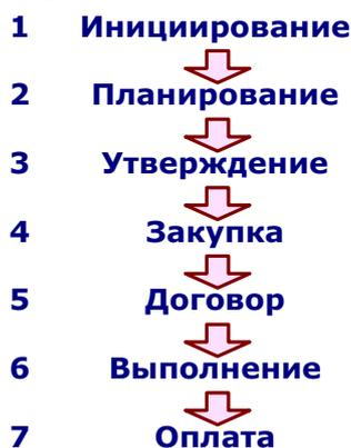
Рис. 2. Процессы (организационно-технологические стадии) проведения ремонта
