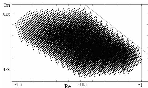
Рис. 6. Расположение области локализации доминирующего полюса ИС
