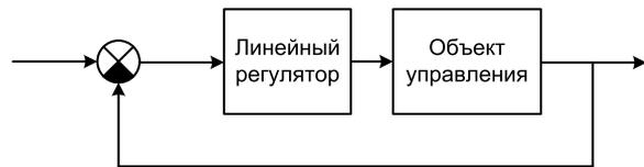
Рис. 2. Схема системы автоматического управления
