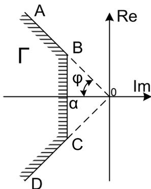
Рис. 1. Область желаемого расположения корней
