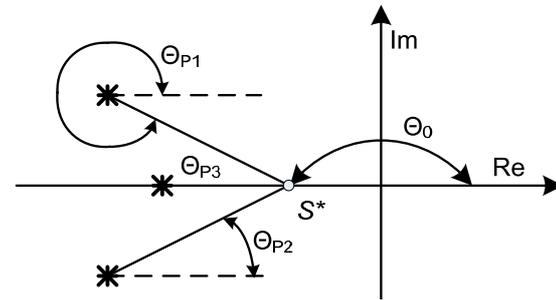
Рис. 4. Пример расположения корней характеристического полинома
