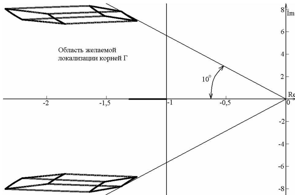
Рис. 5. Области локализации полюсов системы с синтезированным ПИ-регулятором
