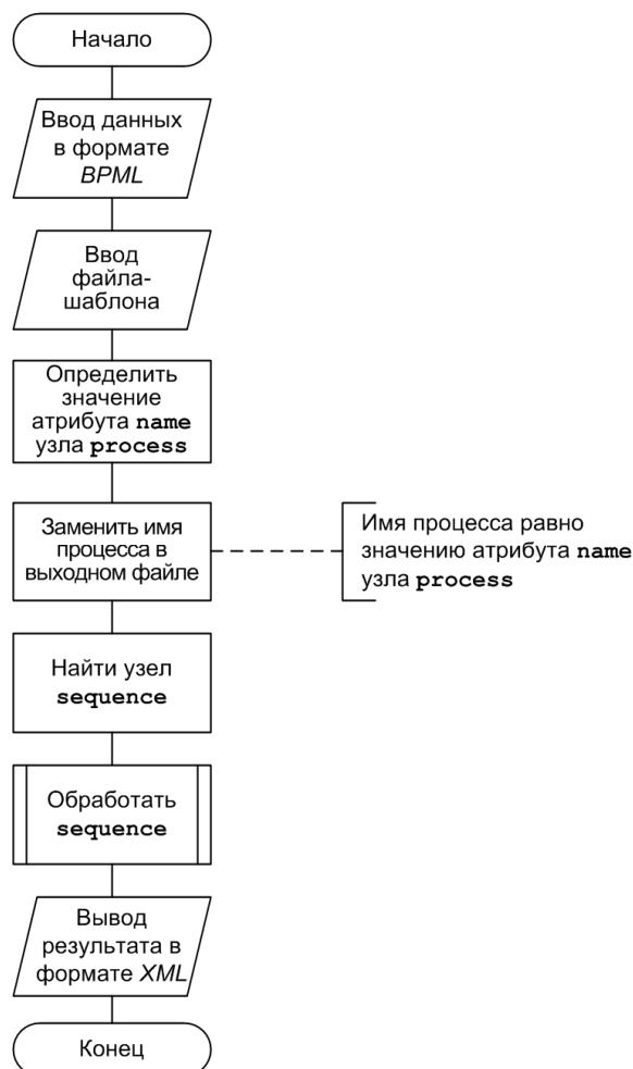
Рис. 5. Алгоритм обработки XML-документа в формате BPMML
