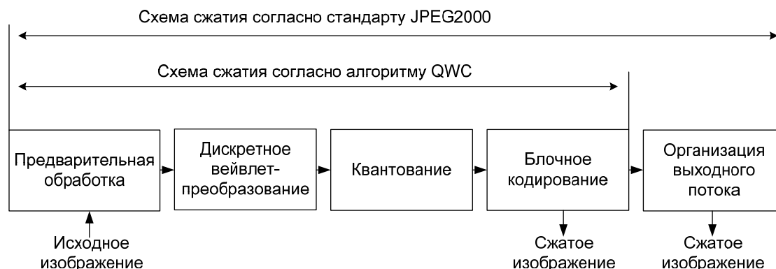
Рис. 1. Схема сжатия изображений стандарта JPEG2000 и алгоритма QWC
