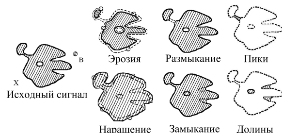
Рис. 1. Эрозия, наращение, размыкание и замыкание, генерация пиков и генерация долин множества точек X с помощью структурирующего элемента B
