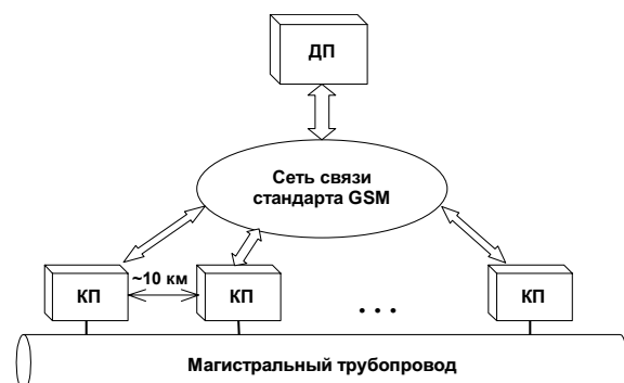
Рис. 1. Схема системы телемеханики с использованием сети связи стандарта GSM
