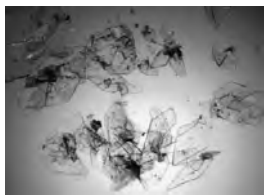
Рис. 1. Вид частиц ОКФ, синтезированных осаждением из растворов \text{pH}=6,5 \tau=72 ч, ув. \times 120
