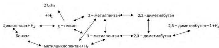
Рис. 1. Модельная схема превращения гексана на цеолитах
