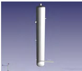
**Рис. 1.** Геометрия реактора жидкофазного алкилирования бензола пропиленом
