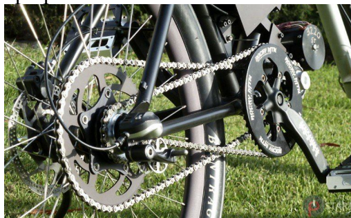
Рис. 3. Пример двигателя в педальном узле
