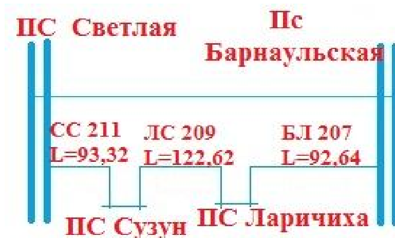
Рис. 1. Участок Алтайской энергосистемы
