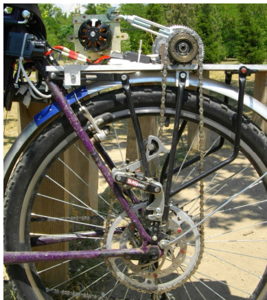
Рис. 4. Пример привода отдельным блоком
