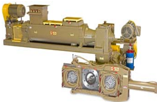
Рис. 4. Сменные матрицы машины Steele 25 – пример мобильности и быстрой переналадки [4]
