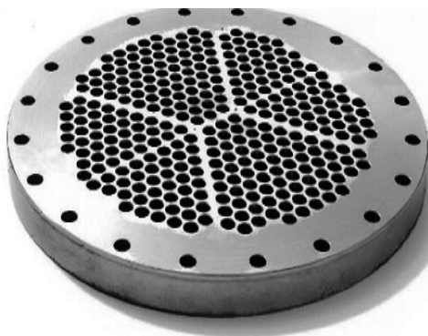
Рисунок 2. Пример плоской неразъемной матрицы для формирования гранулированных удобрений и сорбентов
