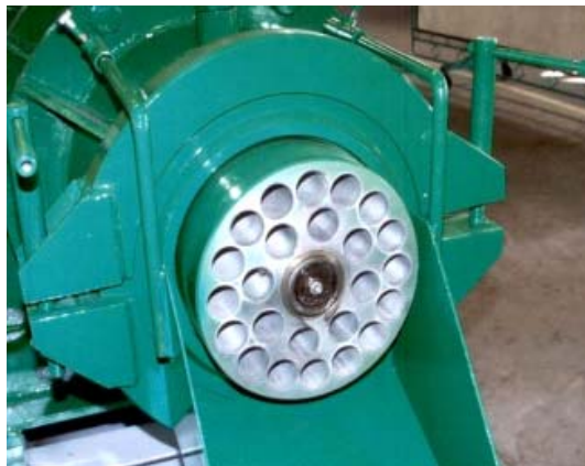
Рис. 3. Матрица шнековой машины ХОТ-31м
