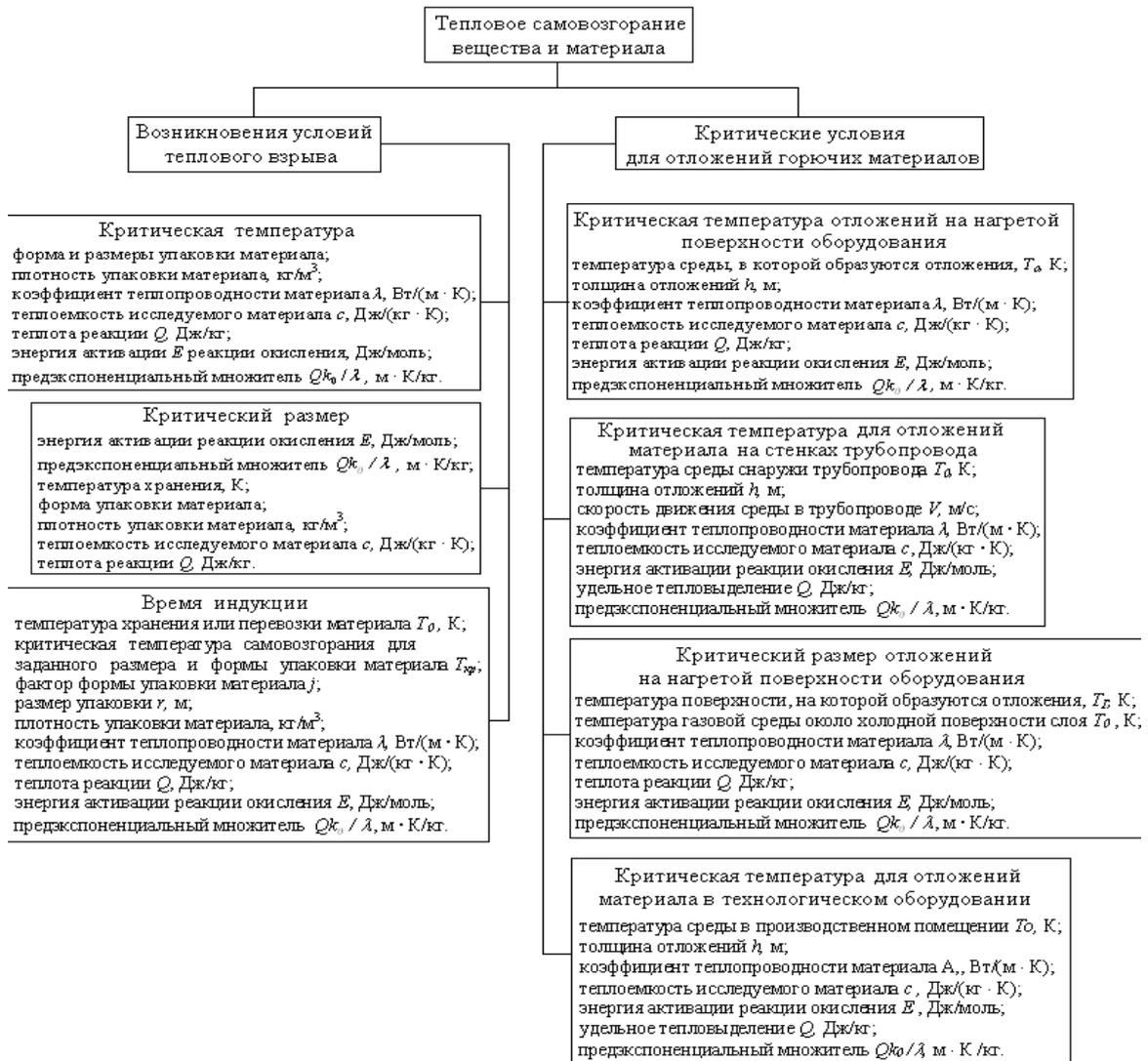
Рис. 1. Дерево событий «Тепловое самовозгорание вещества и материала», основанное на «Методике определения условий теплового самовозгорания веществ и материалов»
