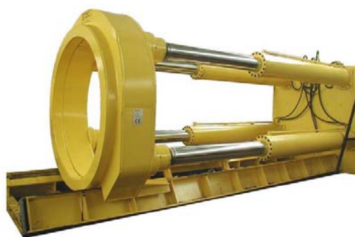
Рис.5. Домкратная станция прессового типа
