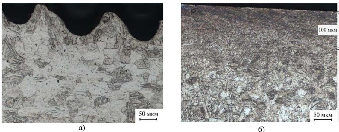
Рис. 6. Металлографическое изображение поверхности титанового сплава ВТ1-0 после механической обработки (а) и после последующей ультразвуковой обработки (б)
