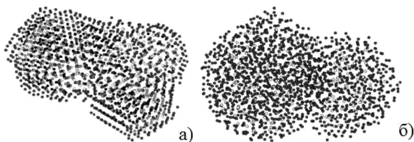
Рис. 1. Эволюция кластер  $\text{Cu}_{1460}$  в зависимости от температуры нагрева: а)  $T = 100$  К, б)  $T = 1100$  К
