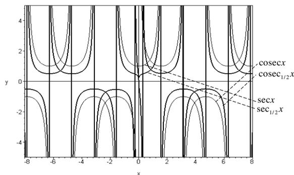
Рис. 3. Графики функций  $\sec_{1/2}x$ ,  $\operatorname{cosec}_{1/2}x$ ,  $\sec x$ ,  $\operatorname{cosec} x$
