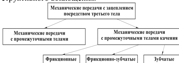
Рис. 5. Классификация механических передач с зацеплением посредством третьего тела
