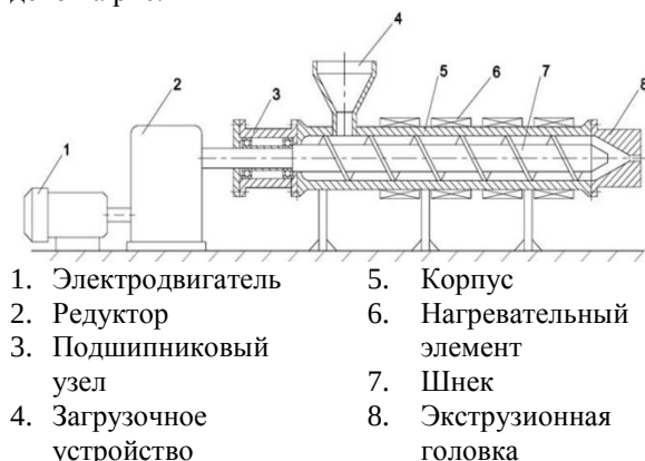
Рис 1. Установка экструдера
