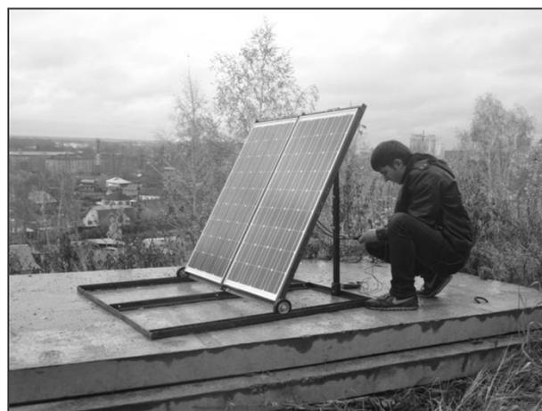
Рис.2 Измерение мощности панели на разработанной конструкции
