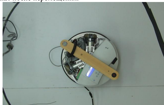
Рис. 2. Определение координат происходит по поиску цвета, излучающего светодиодами, залепленными на роботе.
