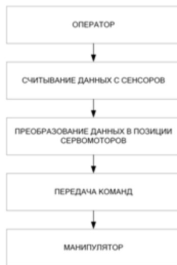
Рис.2. Алгоритм работы системы управления
