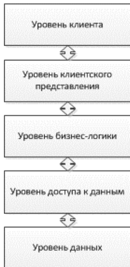
Рис. 20 – Типовая многоуровневая клиент-серверная архитектура
