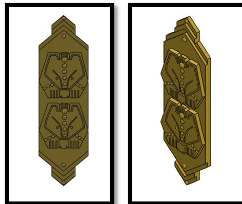
Рис. 2 3D модель отливки, созданная в программе SolidWorks
