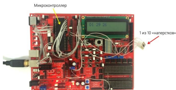
Рис. 4. Реализация TouchSpace на отладочной плате
