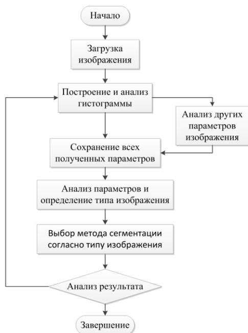
Рис. 2. Схема автоматического подбора алгоритма сегментации изображения
