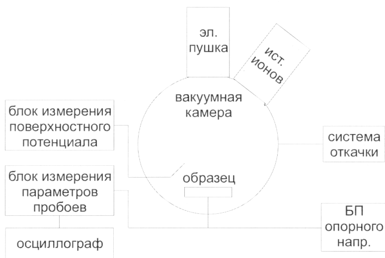
Рис. 7. Структурная схема испытательного стенда
