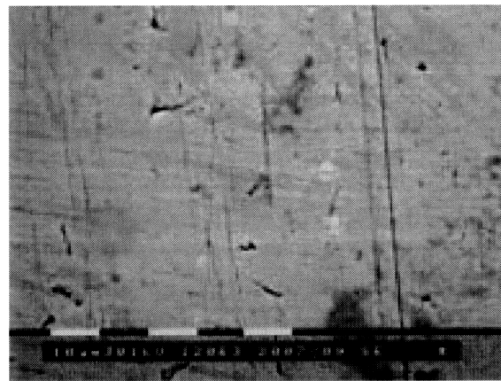
Рис. 4. Оптические изображения поверхности образцов аустенитной нержавеющей стали 12Х18Н10Т, полученные на РЭМ: а – исходном, б – после электролитического введения водорода в течение 15 мин, в – после электролитического введения водорода в течение 60 мин, г – после электролитического введения водорода в течение 120 мин
