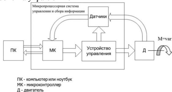
Рис. 1. Схема подключения прибора-идентификатора
