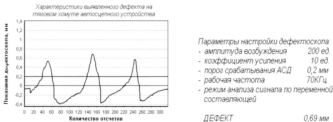
Рис. 2. Дефектограмма контроля тягового хомута автосцепного устройства
