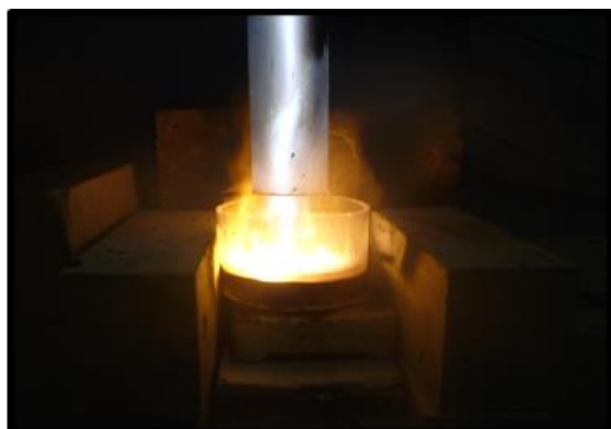
Рис. 3 Плазменная иммобилизация твердых дисперсных продуктов ИЛО в расплаве хлорида натрия в воздушной плазме ВЧФ-разряда.
