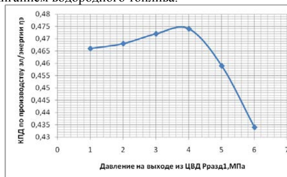
Рис. 4 - График зависимости изменения КПД по выработке эл/энергии от давления на выходе из ЦВД для перегрева пара со сжиганием водородного топлива.
