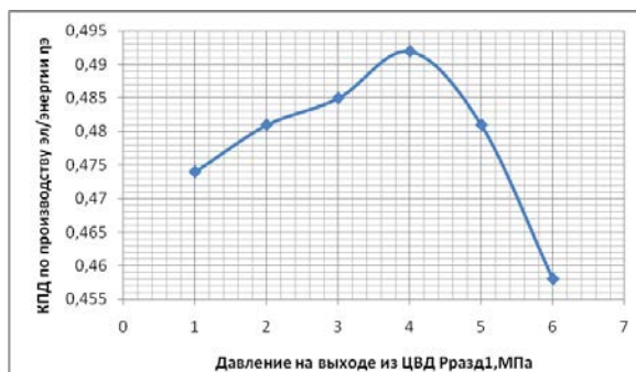
Рис 3. – График зависимости изменения КПД по выработке эл/энергии от давления на выходе из ЦВД для газового перегрева.
