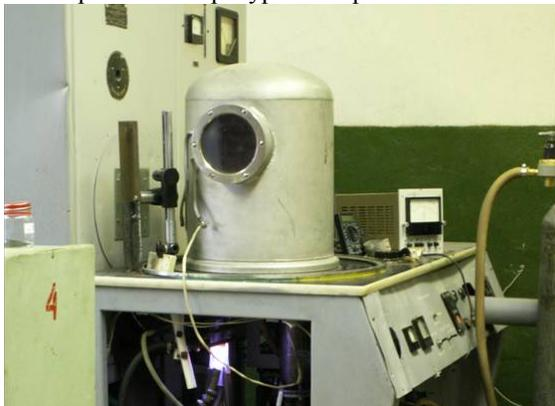
Рис.1 Вакуумный блок установки для получения ВЧ плазмы.
