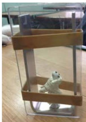
Рис.4. Установка пластилиновой модели в пресс-форму
