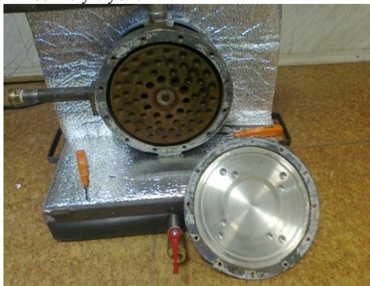
Рисунок 1 – Общий вид дискового кавитационного теплогенератора.
