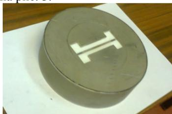
Рис. 3. Окно ввода СВЧ импульса на базе H – образного волновода с фторопластовой вставкой
