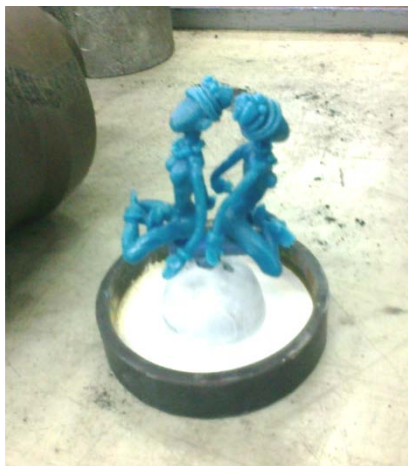
Рис. 4 Восковые модели, прикрепленные к литниковой системе
