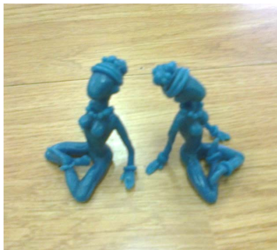
Рис. 3 Восковые модели. Внесены изменения в форму.
