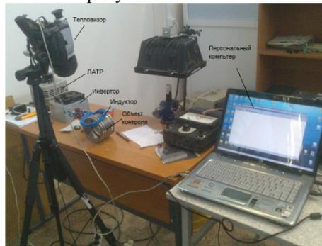
Рисунок 3. Тепловизионный дефектоскоп с индукционной стимуляцией.
