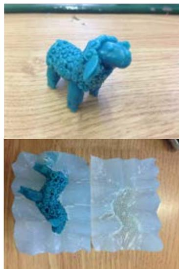
Рис.7. Восковая модель и разрезанная пресс-форма
