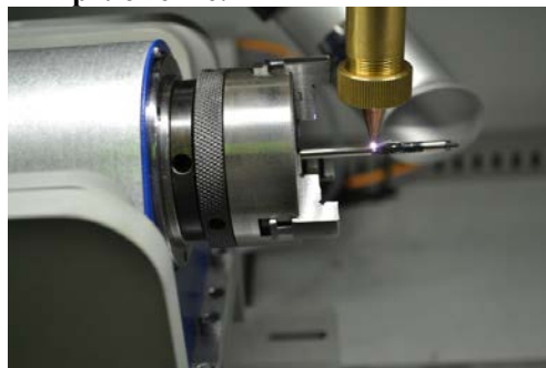
Рис.1 – процесс изготовления стента на стадии лазерной резки
