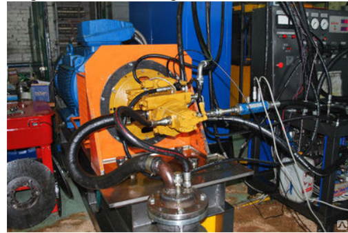
Рис.3. Стенд для тестирования клапанов и насосов
