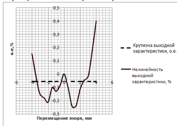
Рис. 3. Вид выходной характеристики датчика преобразователя и нелинейности выходной характеристики датчика.
