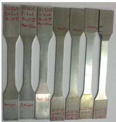
Рис. 1. Алюминиевые и титановые образцы после поверхностного электронно-лучевого структурирования, подготовленные для оценки прочностных характеристик
