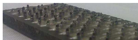
Рис. 2. Объемная модификация медной поверхности (высота игл 2 мм)
