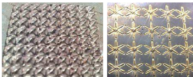
Рис. 3. Примеры поверхностного модифицирования на нержавеющей стали X18H10T (а) и на титане ВТ0(б)
