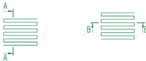
Рис. 3. Сечения единичного спеченного слоя а) поперечное, б) продольное
