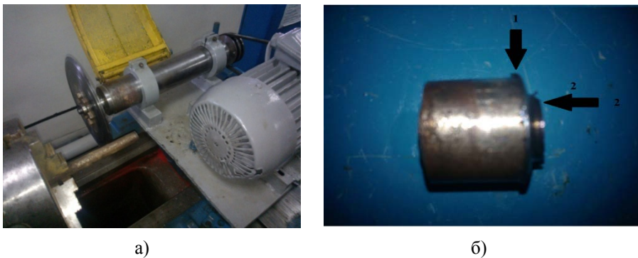
Рис. 1. Специальная установка для ТФО (а) и образец (б)
