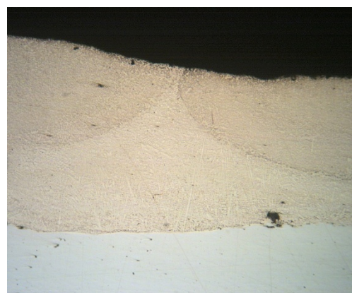
Рис. 2. Поперечное сечение композиционного полосчатого покрытия из сплава ПГ-12Н-01 и бронзы ПГ-19М-01 x50
