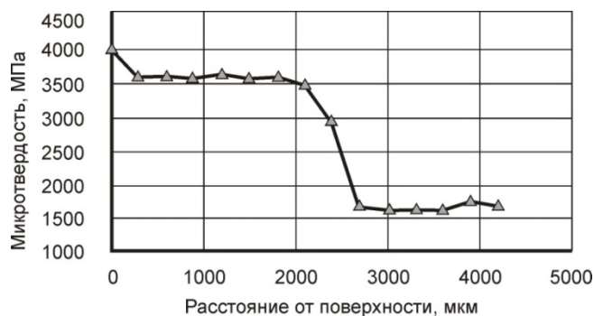
Рис. 2. График распределения микротвердости по сечению образца
