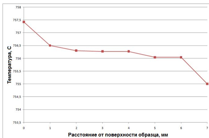
Рис. 3. Распределение температур в образце стали 34ХН1М при электролитно-плазменном азотировании
