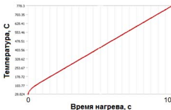
Рис. 2. Зависимость температуры образца стали 34XN1M от времени нагрева
