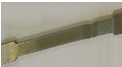
Рис. 1. Фотография разрушенного образца сварного соединения из стали 15XCHD
