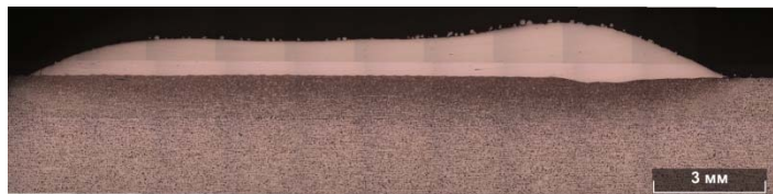
Рис. 5. Структура наплавочного валика, полученного при мощности излучения 12,5 кВт, скорости перемещения образца 500 мм/мин, расходе порошка 150 г/мин, синусоидальное сканирование, толщина покрытия 0,9-1,7 мм
