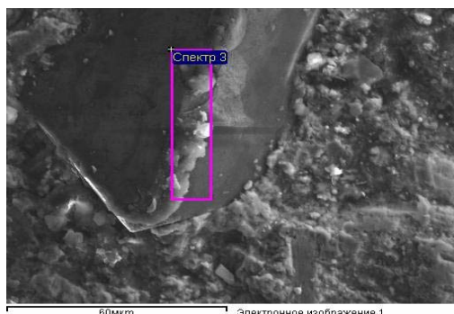
Рис. 3. Налипы на режущей части алмазного зерна
