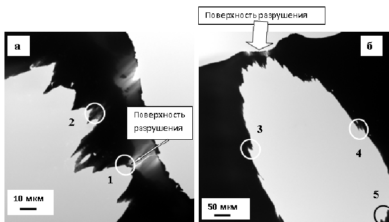
Рис. 2. Общий вид (б) и приповерхностная часть (а) фольги, приготовленной методами ионного утонения (образец разрушен в результате ползучести в магнитном поле). Овалами выделены области фольги, подвергнутые ПЭМ анализу; на (а) – 1 – поверхность разрушения; 2 – слой на расстоянии ~20 мкм от поверхности разрушения; на (б) – слои, расположенные на глубинах 3 – ~265 мкм; 4 – ~325 мкм; 5 – ~610 мкм
