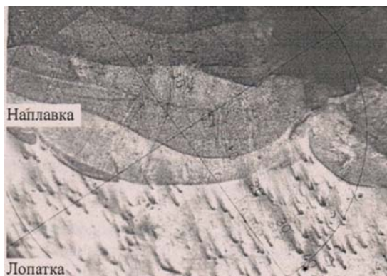
Рис. 7. Граница «наплавка – лопатка» в сечении микрошлифа х200
