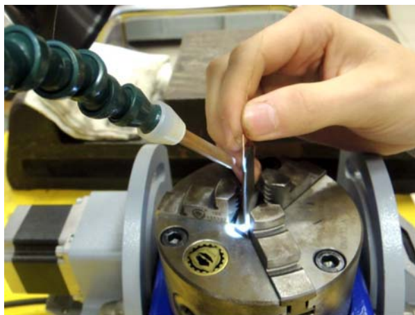
Рис. 3. Процесс наплавки торца пера лопатки
