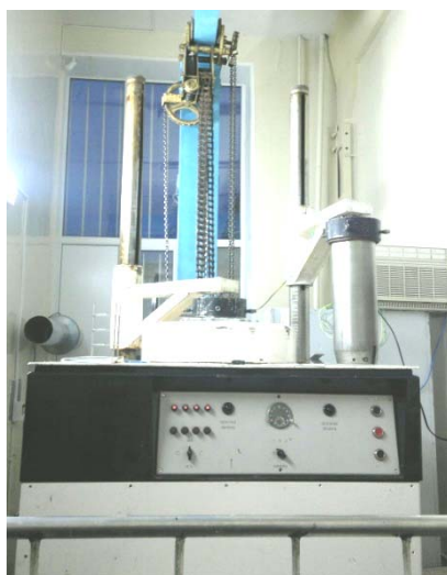
Рис. 1. Гамма-установка «Исследователь» на изотопе Co^{60}
