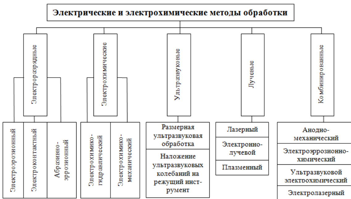
Рис. 2. Лазерные и электронно-лучевые методы обработки материалов, как подвид электрофизических и электрохимических методов [2]
