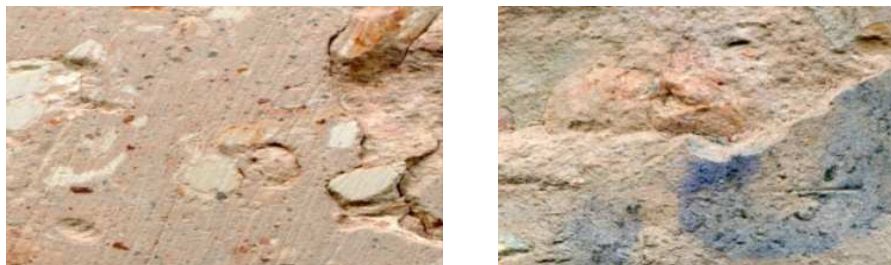
Рис. 2. Образцы состава «глина-шлак» после обжига
