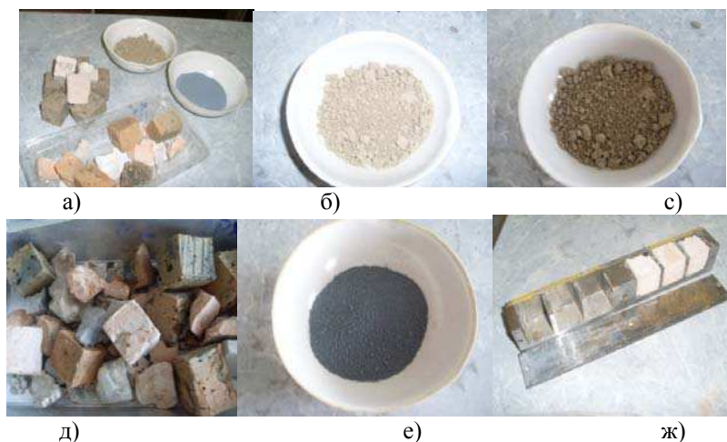
Рис. 1 а) Керамические образцы после обжига; б) Металлургический шлак; в) Глина д) Керамические образцы; е) Микрокремнезем; ж) Форма для образцов
