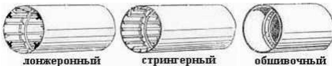
Рис. 3. Основные разновидности балочных фюзеляжей
