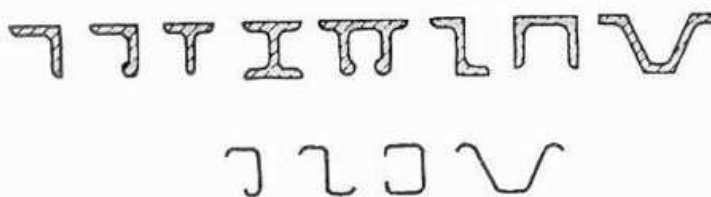
Рис. 4. Основные разновидности лонжеронов и стрингеров
