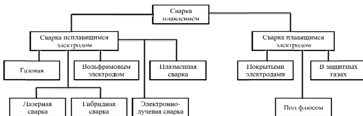
Рис. 1. Способы сварки плавлением тонколистового металла
