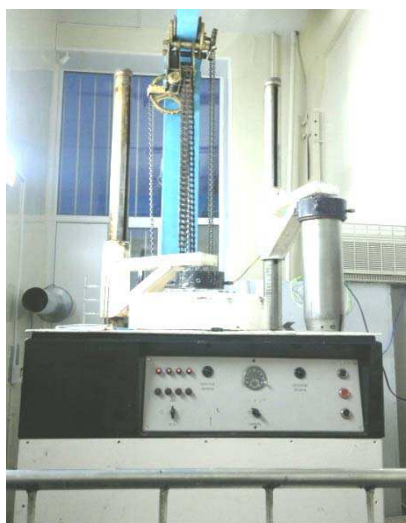
Рис. 1. Гамма-установка «Исследователь» на изотопе \text{Co}^{60}
