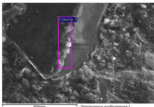
Рис. 3. Налипы на режущей части алмазного зерна
